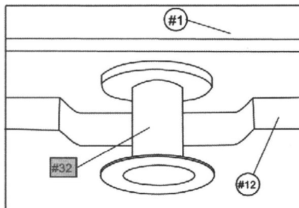
14. Serrez fermement tous les écrous et vis sur les pieds (qui avaient été serrés à la main lors de l'étape 4) à l'aide d'un tournevis. Voir le schéma suivant :
